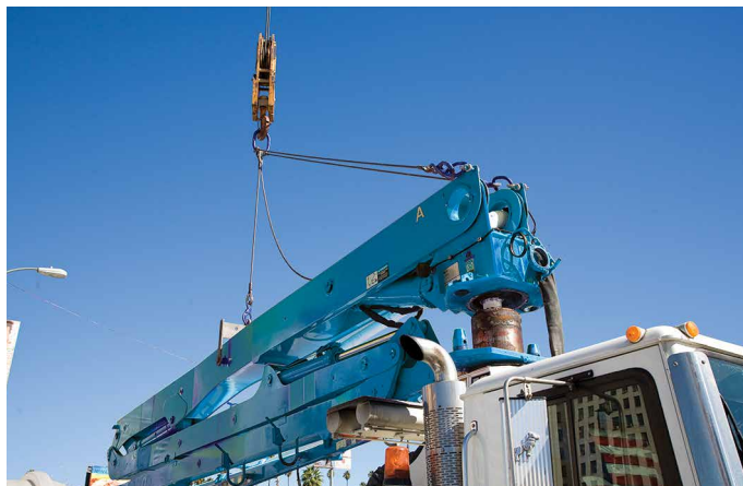
PASO 2: Desconecte la pluma y levántela
