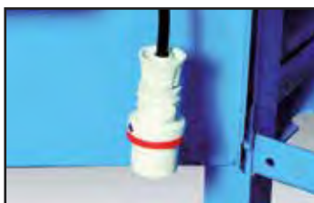
Clavija de conexión protegida internamente.
